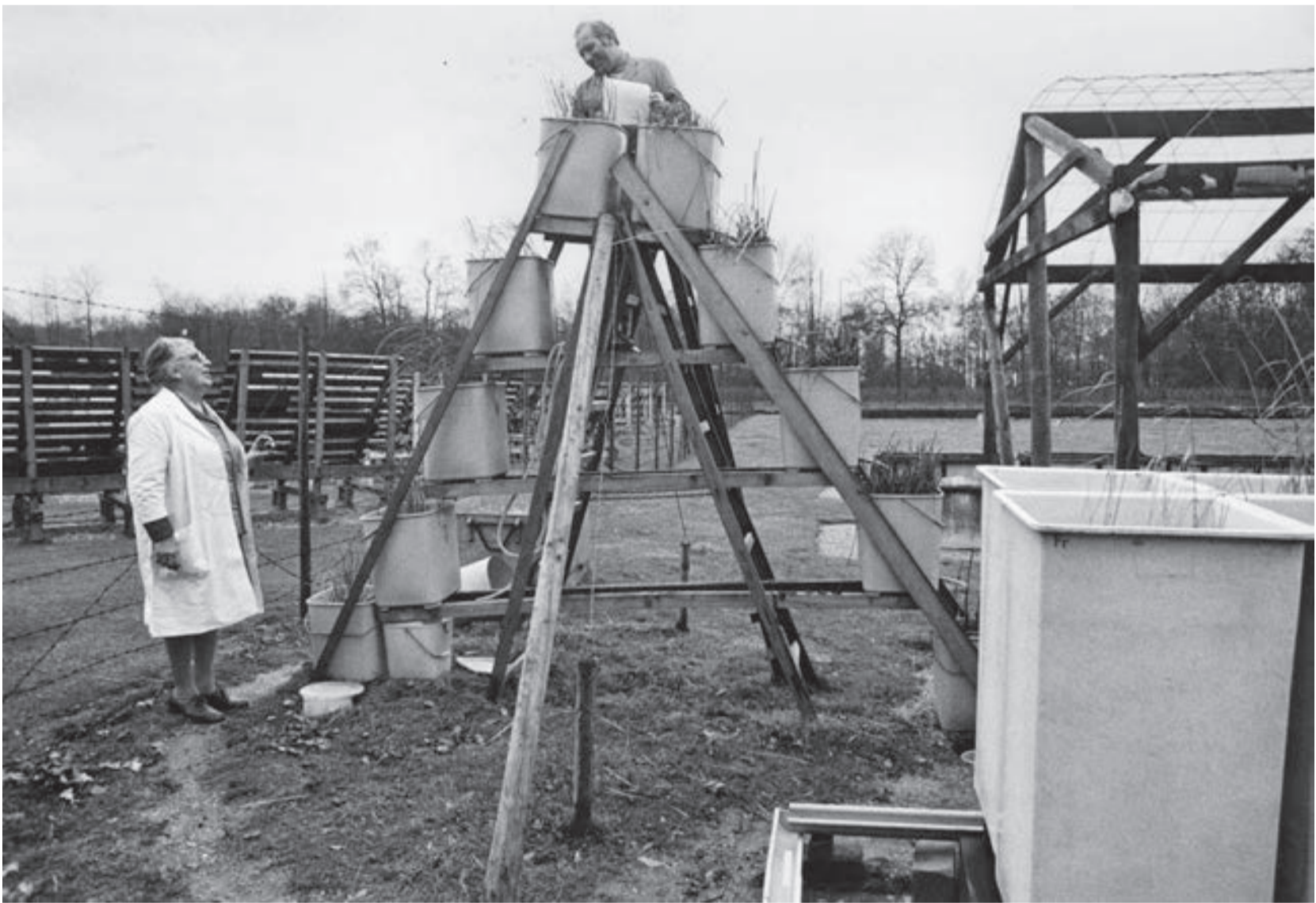
Krefelder System - Versuchsaufbau aus Dachlatten, Maschendraht und Plastikkübeln zur Reinigung von Abwasser
